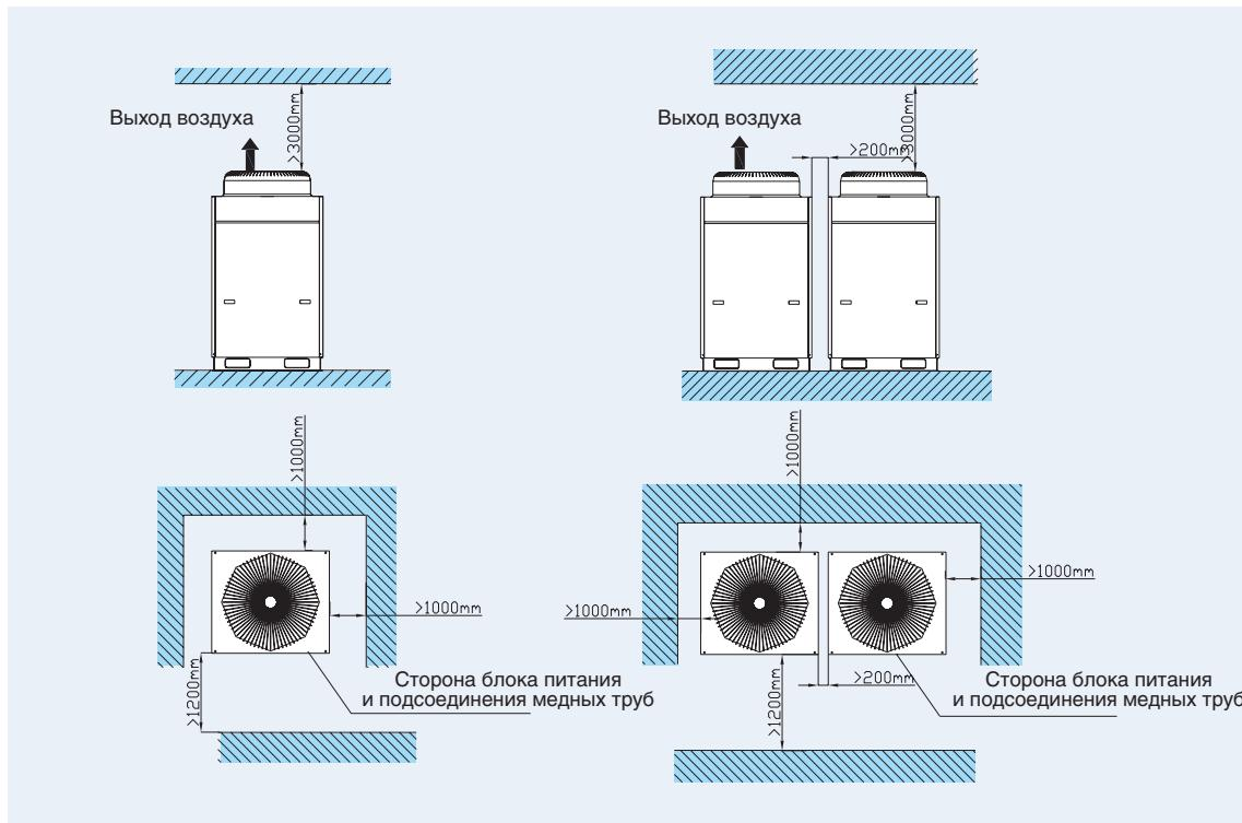
Требования по размещению группы из трех блоков с одним вентилятором на каждом блоке и группы из двух блоков с двумя вентиляторами на каждом блоке.
